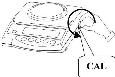
Die Justierung läuft automatisch ab. [**CAL.on**] wird blinkend dargestellt.
