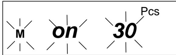
5. Legen so viele Zählteile auf die Waage, wie die eingestellte Referenzstückzahl verlangt.
