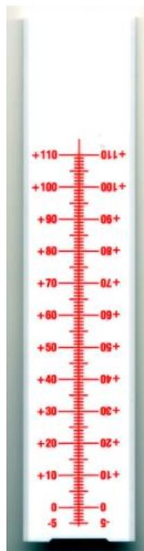
Lineal: dieses wird mit der Anzeigekante „-5“ durch den Schlitz der Messplatte geführt, so dass es zwischen den Leitkanten des Messschemels mit der Aussparung satt auf der mittleren Erhebung aufsitzt. Die Messplatte zeigt nun auf der roten Skala den Versatz, die rote Mittellinie des Lineals auf der schwarzen Skala die Rissbreitenveränderung an. Das Lineal wird nach der Ablesung aus der Messplatte herausgenommen und für Folgeablesungen an einem sicheren Ort verwahrt.
