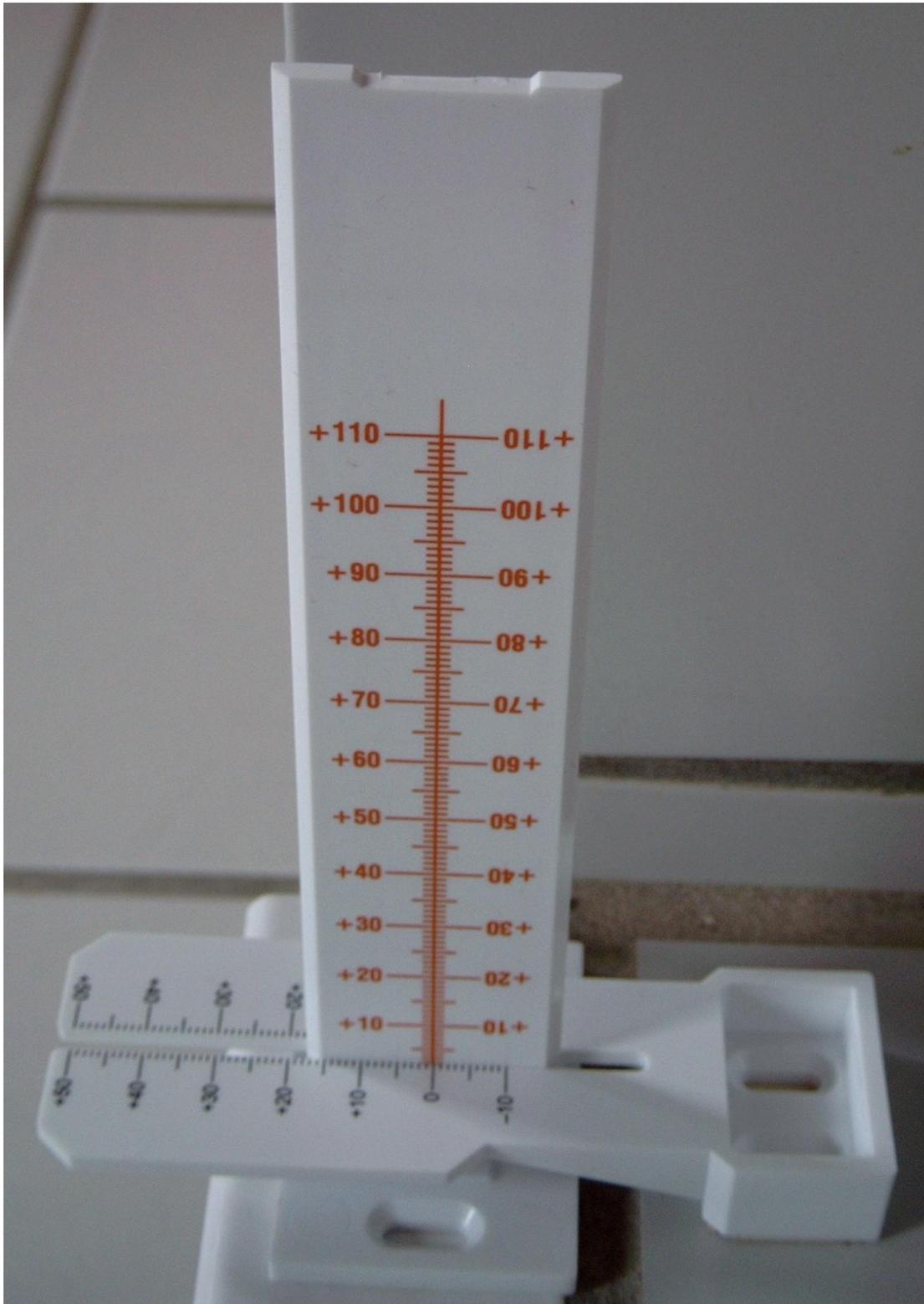
**tcl - i • RISSMONITOR© TYP TT 4 Mauerwerksversatz**
