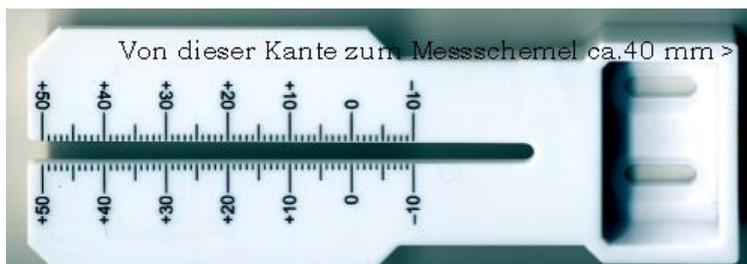
Messplatte: diese wird auf dem vorspringenden Bauteil so installiert, dass die hintere Kante ca. 40 mm von der ihr zugewandten Kante des Messschemels entfernt ist und die Messplatte den Messschemel mittig rechtwinklig überträgt.
