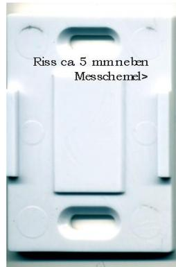
Messschemel: dieser wird auf dem zurückspringenden Bauteil ca. 5 mm neben dem Riss so installiert, dass die Langlöcher rechtwinklig zum Riss liegen
