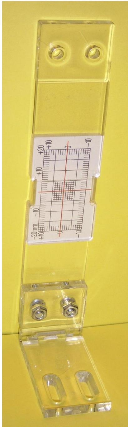
**tcl - i • RISSMONITOR**© TYP TT 3 Bodenplatte/Geschossdecke
