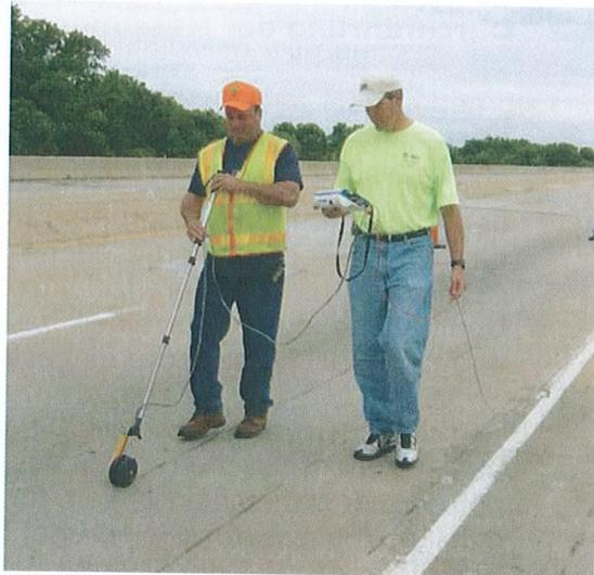
**Abb. 4: Messung mit Radelektrode**
