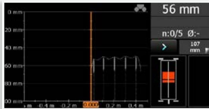
*Rote Markierung zur einfachen Identifizierung von Überdeckungen, bei denen das eingestellte Minimum unterschritten wird*
