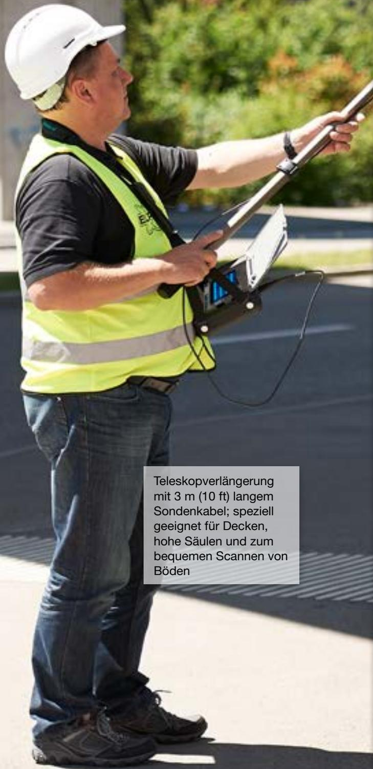
Teleskopverlängerung mit 3 m (10 ft) langem Sondenkabel; speziell geeignet für Decken, hohe Säulen und zum bequemen Scannen von Böden
