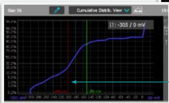
➔ Anpassbare Cursors definieren Korrosionsschwellwerte
