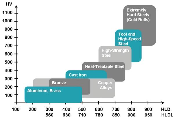
Der Härtegrad von Metallen wird in verschiedenen Härteskalen angezeigt: HL (Leeb), HRC (Rockwell C), HB (Brinell), HV (Vickers) usw. Mit dem Piccolo 2 / Bambino 2 können Messungen rasch vorgenommen und in der gewünschten Härteskala angezeigt werden.
