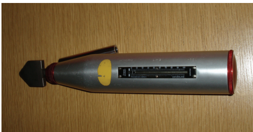
Abbildung 1: Rückprallhammer mit modifiziertem Schlagbolzen
