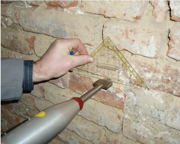
Abbildung 10: Ermittlung der Eindringtiefe
