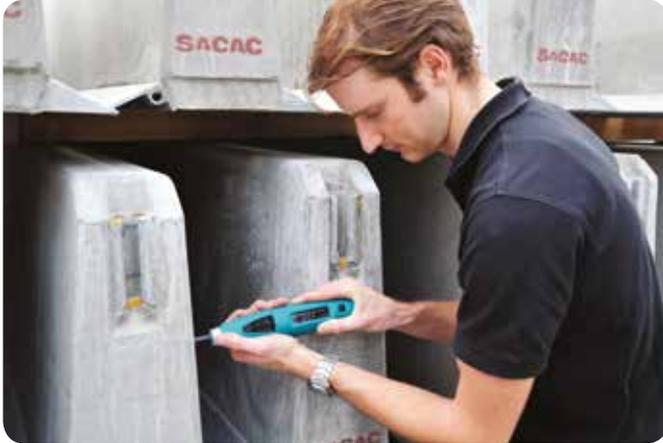
**ST/PC Typ N/L:** Der modernste Rückprallhammer der Welt mit unerreichter Streuungscharakteristik, Robustheit und maximalem Messbereich.
