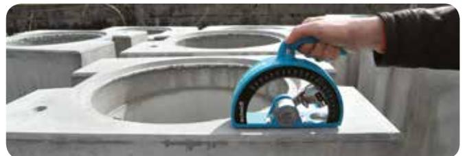
**Typ PT:** Ausgestattet mit einem Schlagbolzen mit grösserer Oberfläche eignet sich dieses Gerät vor allem für die Prüfung von weicheren Materialien wie Leichtbeton, Gipskartonplatten und frischem Beton. Es wird häufig zur Bestimmung des richtigen Zeitpunkts für die Entfernung von Schalungen verwendet.
