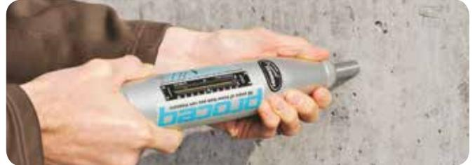
**Typ N/L:** Das Mass, an dem alle Rückprallhämmer gemessen werden, und die Basis sämtlicher internationaler Normen für Rückprallhämmer. Lieferbar mit unterschiedlicher Schlagenergie, um die Prüfung einer Vielzahl von Materialien und Strukturen zu erlauben.
