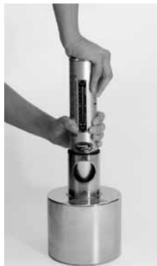
Fig. 3.1 Contrôle de fonctionnement du scléromètre à béton (modèles illustrés: N/L)
