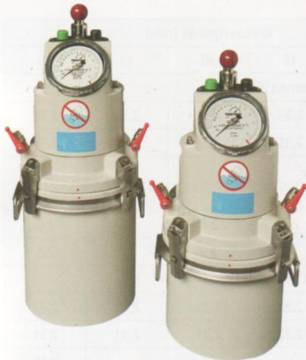
**Bild 1:** Luftgehaltsprüfgeräte mit Volumina von 8 l (links) und 5 l (rechts)
