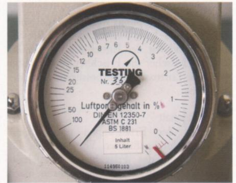
**Bild 2:** Skala des Manometers am 5-l-Luftgehaltsprüfgerät
